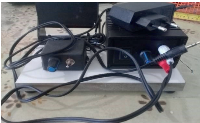
Figura 4.3 - Visão frontal da base com amplificador e cabo de áudio com as duas entradas RCA conectadas.
